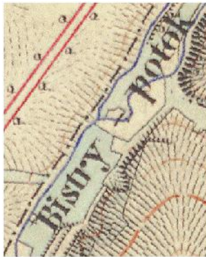
Obr. 2.10: Vodní toky vektorizujte „od soutoku po soutok“. Atribut „Nazev“ vyplňujte doslovně dle originálního mapového listu. Názvy nepočesťujte! (zdroj [1])
