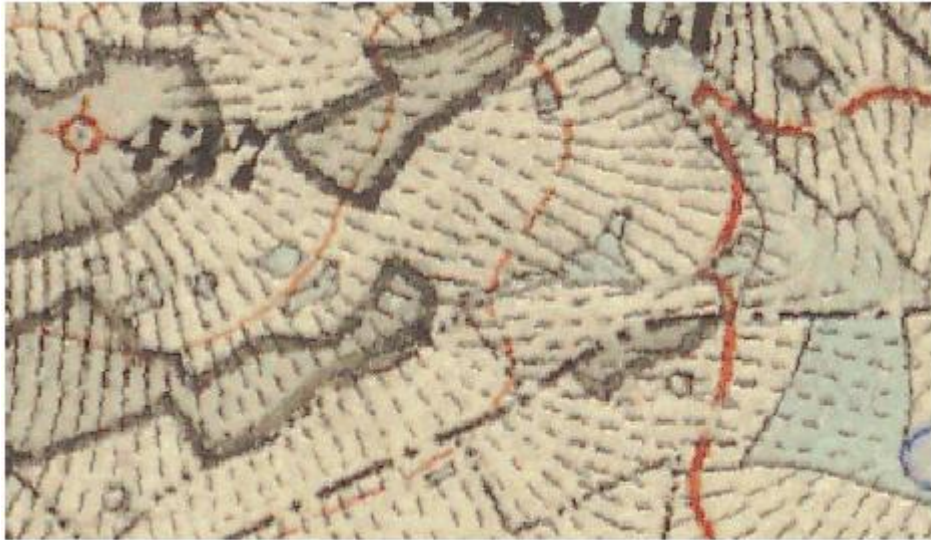
Obr. 2.11: Kóta a vrstevnice. Od leva: kóta (437m.n.m.), mezilehlá vrstevnice (420m.n.m.), doplňková vrstevnice (410m.n.m.) a hlavní vrstevnice (400m.n.m.). Doplňková vrstevnice 430m.n.m je ukryta v hranici lesa (její pokračování je patrné v levém horním rohu). (zdroj [2])
