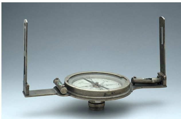
Průzor s buzolou k určování magnetických azimutů měřických směrů
