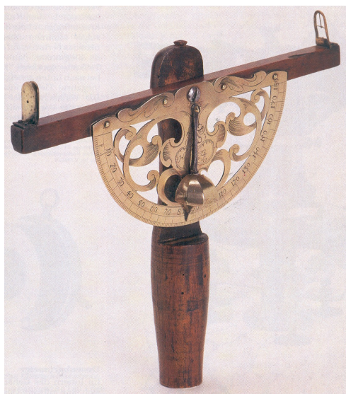
Průběh terénního vyměřování pomocí astronomického kvadrantu
