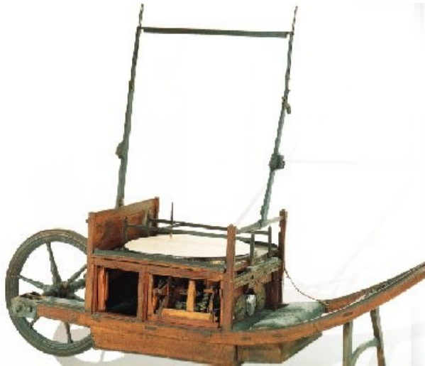
Kombinace měření vzdáleností a určování směrů na měřenou vzdálenost pomůckami umístěnými na trakaři
