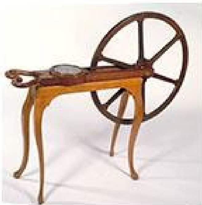
Ruční kolo - hodometr - na měření vzdáleností mělo připojen kompas pro orientování změřených vzdáleností
