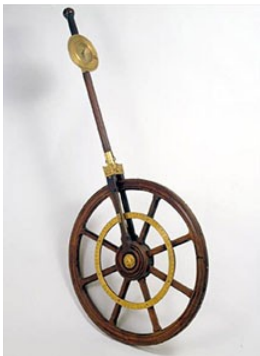
Ruční kolo - hodometr - na měření vzdáleností mělo připojen kompas pro orientování změřených vzdáleností
